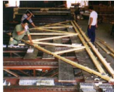
Obr.8 Technológia výroby väzníkov
