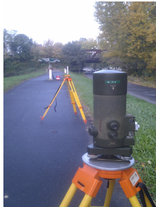
Obr. 5: Testovanie systému ATR na pravostrannej hrádzi Dunaja pri Starom moste
