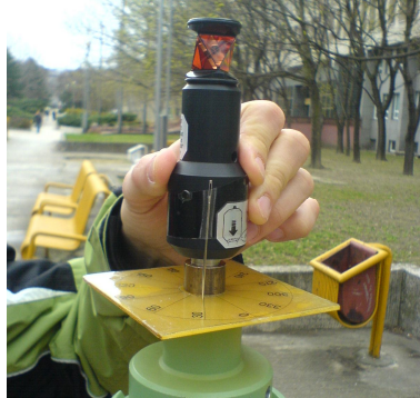
Obr. 4: Odrazový mini hranol Leica GRZ4 s uhlomernou stupnicou
