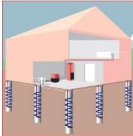
Obr. 6: Spirálovitě uložené potrubí
