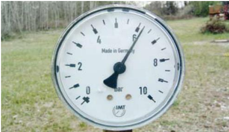
Obr. 9: Tlaková zkouška při 6 barech
