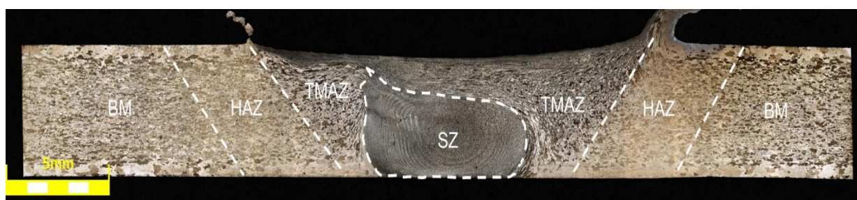
Obr. 6.11. Makrostruktura spoje T81
