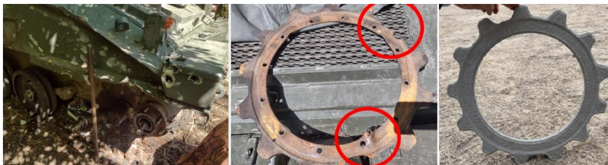
Obr. 1.3. Výroba řetězového kola na Ukrajině, březen 2023. UK Army Report 2023
