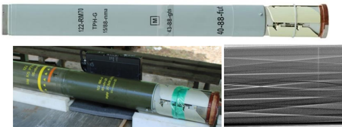
Obr. 6.21. Kontrola stupně degradace TPH u raketových motorů
