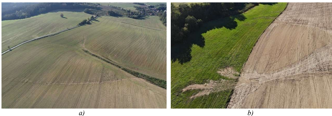
Obr. 11: Ukázka formování odtoku a pohybu sedimentu pomocí UAV a.) uvolnění a transport ve vzniklých drahách soustředěného odtoku b) odnos a sedimentace v ploše povodí – lokalita Býkovice (autor Tomáš Laburda, fotoarchiv katedry K143)
