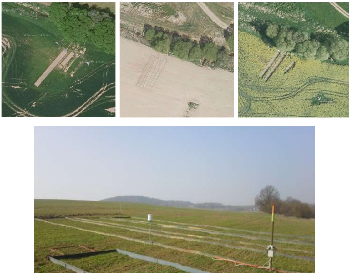
Obr. 6: Ukázka dlouhodobého monitoringu na vymezených odtokových plochách – Býkovice.
