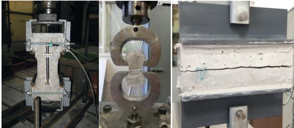
Obr. 45 Zkouška v osovém tahu: (a) zkouška pevnosti cementového kompozitu – mechanické uchycení tělesa [187], (b) zkouška rozhraní tištěných vrstev – mechanické ukotvení tělesa [188], (c) zkouška rozhraní vrstev na cementové bázi – lepený spoj [181]
