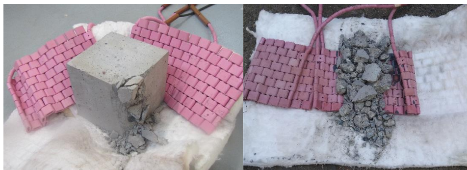
Obr.12 Forma odprýskání betonu: odštěpování kusů materiálu (vlevo) a celkové poškození (vpravo)
