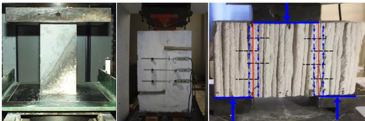
Obr. 47 Zkouška šikmým smykem (vlevo) [197], smyková zkouška na unikátním tělese (uprostřed) [207], smyková zkouška na tělese zhotoveném aditivní technologií (vpravo) [208]
