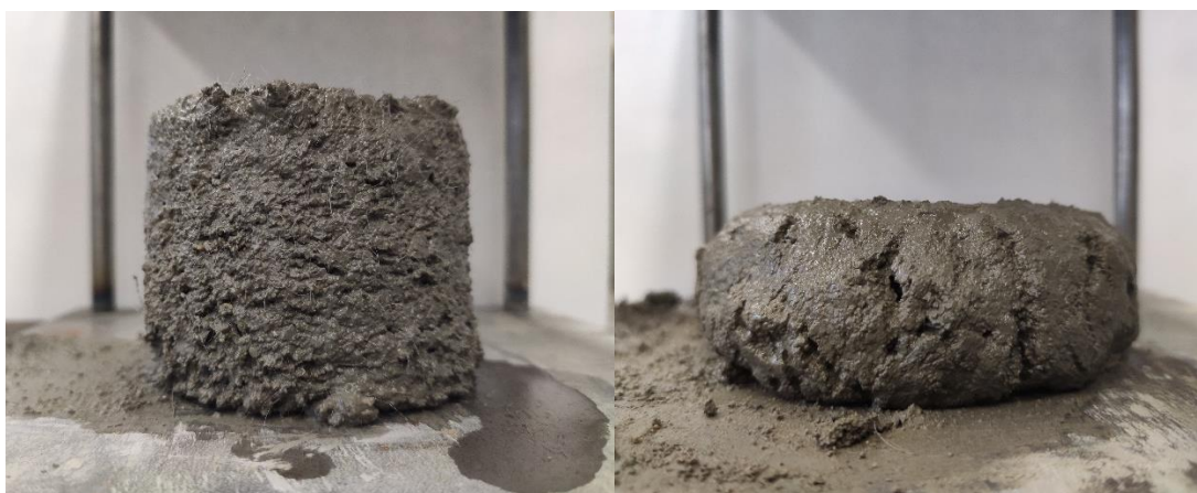
Obr.40 Tvarová stálost čerstvé směsi při shodném zatížení – vláknobeton s polypropylenovými mikro vlákny (vlevo) a prostý beton (vpravo) [169]
