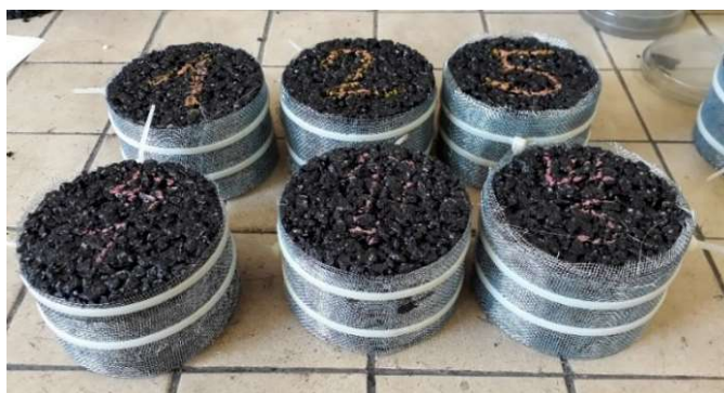
Obrázek 1. Zhutněná asfaltová tělesa zpevněná před laboratorním stárnutím
