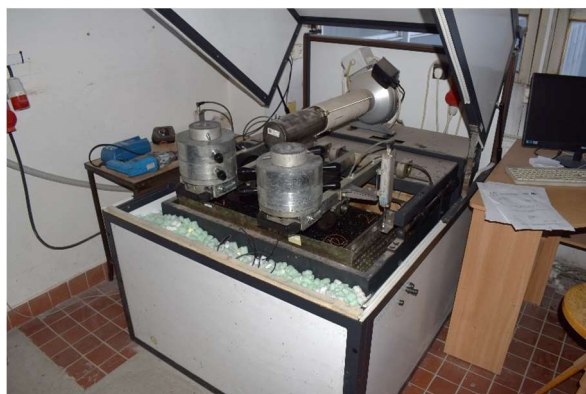
Obrázek 4: Stanovení odolnosti vůči trvalým deformacím
