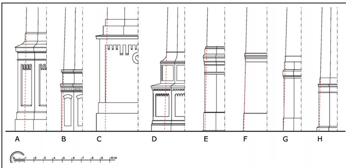
Obr. 23: Demonstrace geometrického pravidla, kdy hypoteticky prodloužený vnější obrys dřívku nesmí vyjít mimo podstavcem vymezený obvod. A: Cukrovar, Dymokury (→ 411). B: Důl Julius, Zastávka. C: Lihovar a chemická továrna, Ignaz Lederer, Mladá Boleslav. D: Cukrovar, Olomouč-Holice (→ 22). E: Přádělna bavlny, Stein, Roztoky (→ 324). F: Strojírny, Slaný (→ 24). G: Pivovar, Bílina (→ 131). H: Cihelna, Emanuel Klotz a spol., Plzeň-Bolevec (→ 145).
