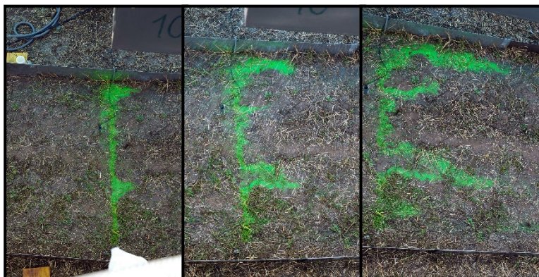
Obrázek 21 – měření rychlosti povrchového odtoku pomocí barevného stopovače. Sledování charakteru povrchového odtoku
