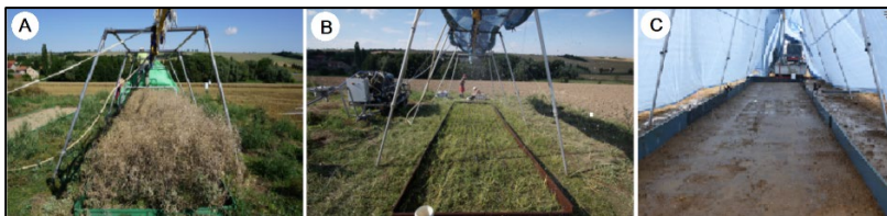
Obrázek 15 – Experimenty s terénním simulátorem na různých vývojových stádiích plodiny a úhoru: a) řepka ve stadiu plné zralosti před sklizní b) řepka ve stadiu růstu c) kypřený úhor během simulace (foto M. Neumann)
