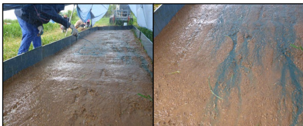
Obrázek 20 – dávkování barevného stopovače pro měření rychlosti povrchového odtoku
