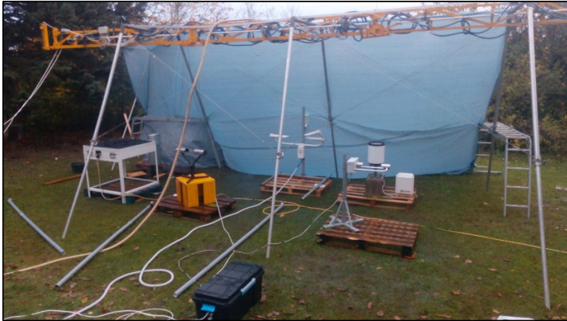
Obrázek 9 – umístění disdrometrů pod dešťový simulátor při jejich porovnání
