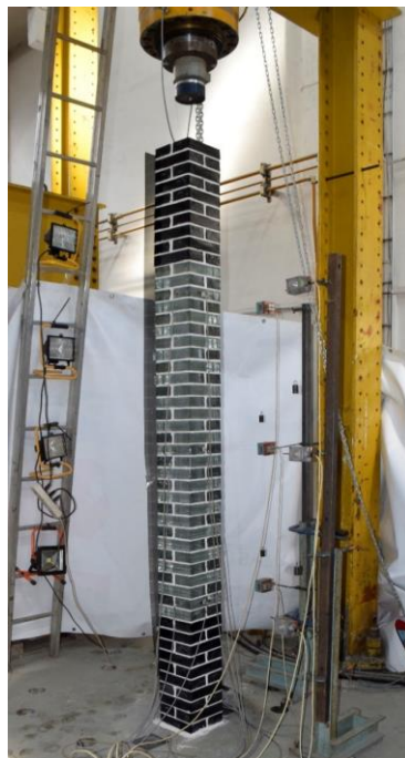
Obr. 35: a) Rozměry pilíře pro experiment 01, b) Uspořádání zkoušky
