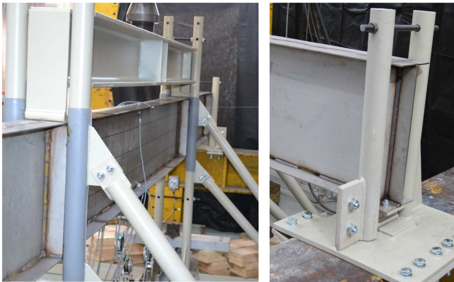
Obr. 12 Schéma zkoušky nosníku a detaily podepření
