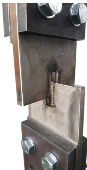
Obr. 37 Zkouška s porušením svaru
