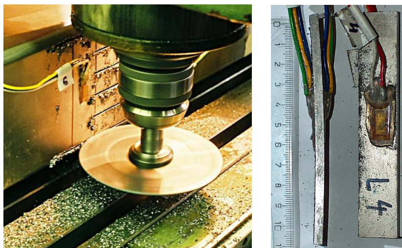
Obr. 8 Řezání profilu a proužky po vyříznutí (profil 120x120x4mm)
