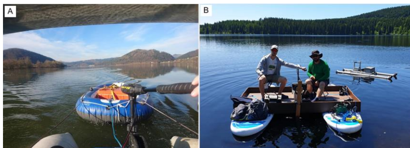
Obr. 11 A - Ukázka umístění georadaru TerraSirch 3000 na taženém člunu. (foto Z. Lend'áková). B – Batymetrická platforma, v pozadí autonomní loď postavená na platformě Arduino.
