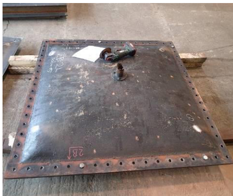
Obr. 42 Odebraný plech puklovky
