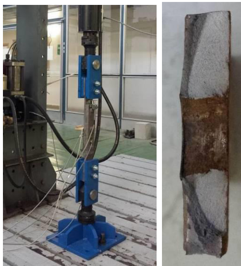
Obr. 24 Vzorek při dynamické zkoušce, pohled na porušení a vzorek
