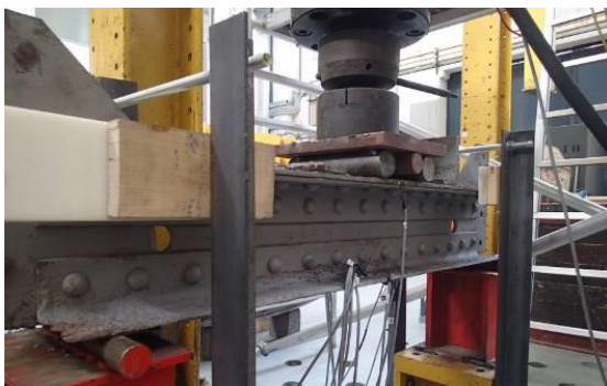
Obr. 17 Ocelový nýtovaný podélník během experimentu
