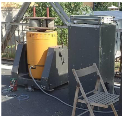
Obr. 29 Elektrodynamický budič TIRAVIB 5140 se signálním generátorem [25]
