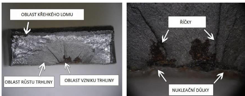
Obr. 22 Únavové poškození zkoušeného vzorku [10]
