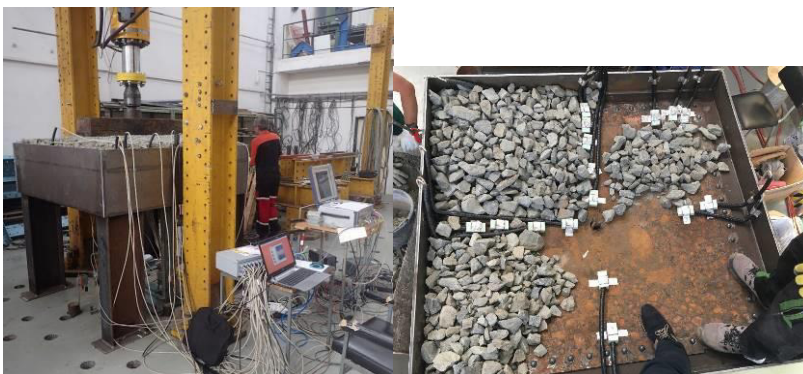
Obr. 44 Zkušební sestava pro experimentální analýzu, zasypávání puklovky s osazenými tenzometry
