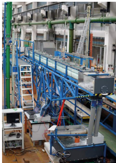
Sklopný žlab pro modelování chodu směsi splavenin
