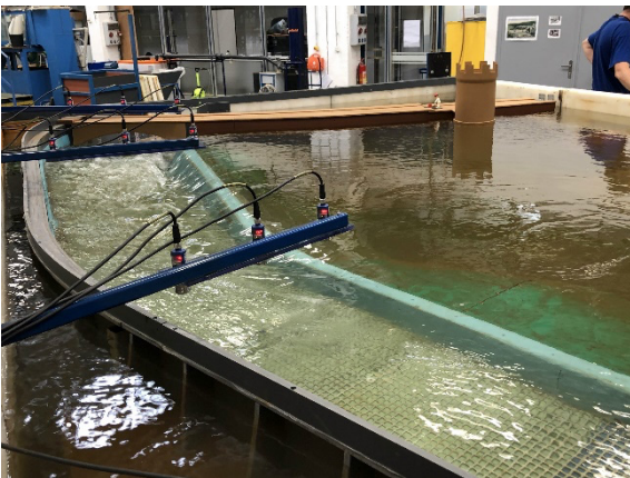
Model bočního bezpečnostního přelivu přehrady Pařížov
