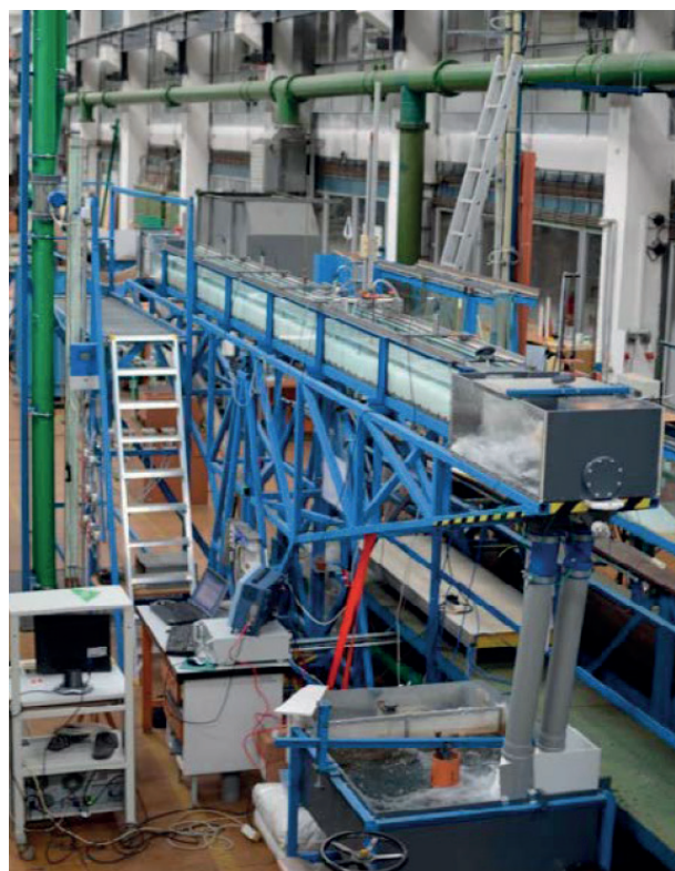
Sklopný žlab pro modelování chodu směsi splavenin
