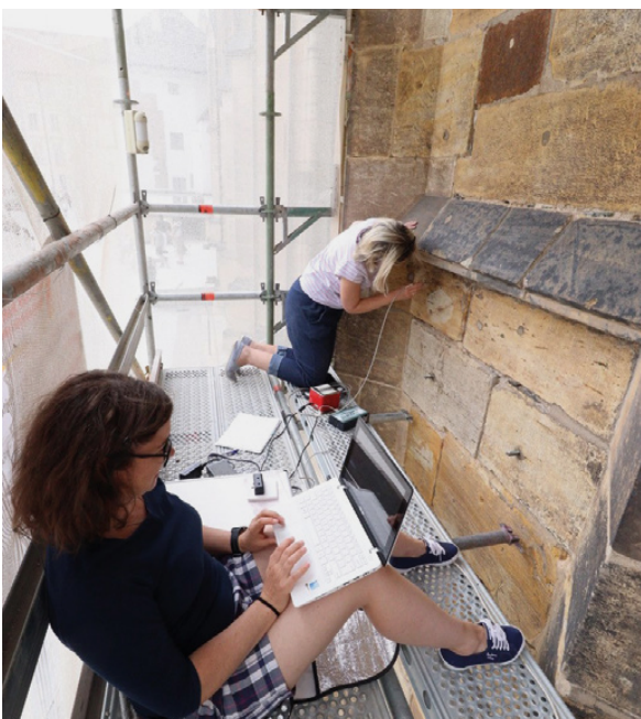
Měření spektrální odrazivosti kvádřového zdiva katedrály sv. Víta (ve spolupráci s K155)
